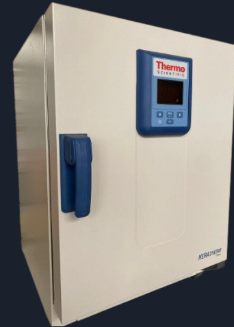
Estufa para Tratamento Hidrotérmico (95°C)
