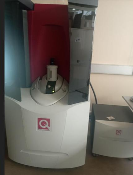
2. Magnetómetro SQUID usado
